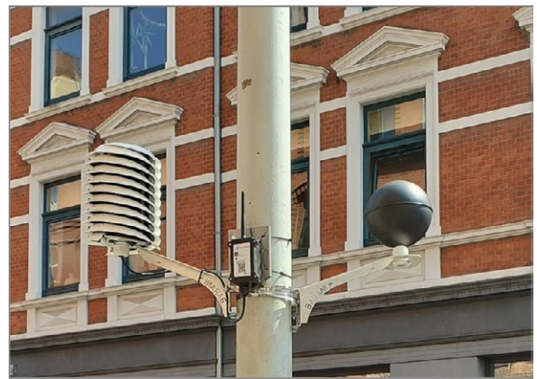
Abb. 84: Beispiel einer Klimamessstation mit Lufttemperatur-/Feuchte-Sensorik in Strahlungsschutzgehäuse (links) und Globe-Temperaturmessung (rechts).
